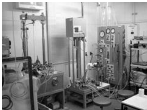
土の強度・変形特性を求めるための試験装置
