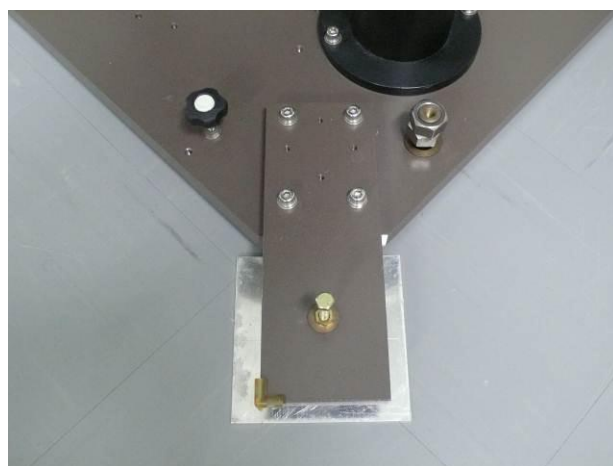
図5 日本電子製 NMR 装置 SCM の ベースプレートを利用した床固定方法
