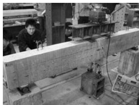
建設工学実験 鉄筋コンクリート梁の載荷
