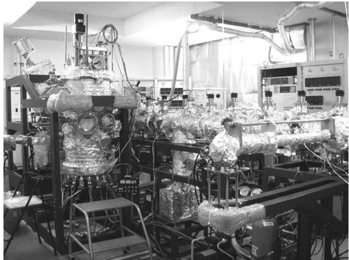
分子線エピタキシー (MBE) 装置
