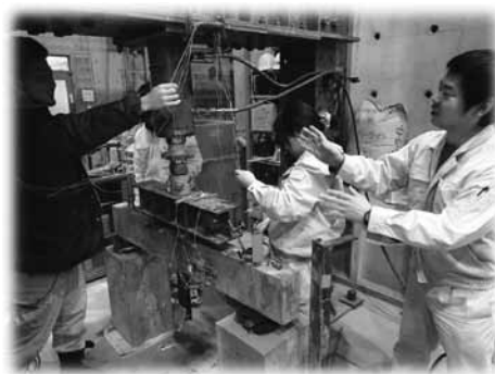
鉄筋コンクリート梁載荷実験
