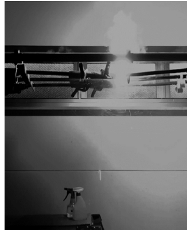
図 3 高圧線間短絡再現の様子
