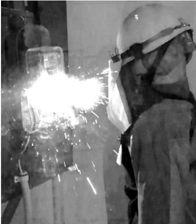
図 2 低圧計器短絡再現の様子
