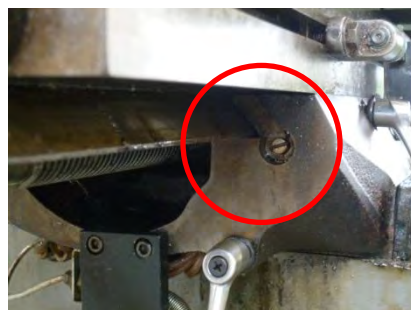
スライド面のカミソリ調整。 ○内のねじの締め付けで調整を行う。
