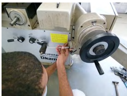
平面研削盤切込装置の調整。安定した切込みを行うには，数箇所の調整を行う必要がある。
