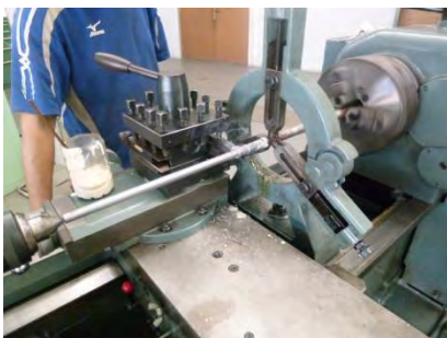
旋盤での長軸の加工。バイトにも工夫し、ビビリが少ないようにしている。
