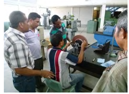
平面研削盤砥石のバランス調整中
