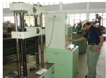
故障しているアムスラー型圧縮試験機 圧力が 100kN まで上がらなかったが、 下部の油圧バルブを調整し、修復した
