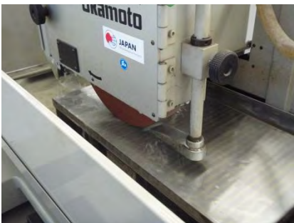
故障している平面研削盤 自動 でテーブルを左右に振る際に左 側に戻らない
