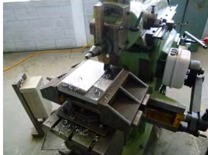
購入した鋼板をシェーパにて六面を加工する
