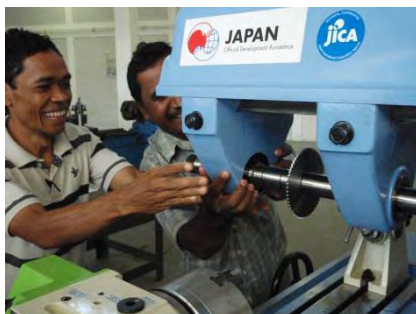
工具（メタルソー）を横フライス盤の主軸に取り付ける
