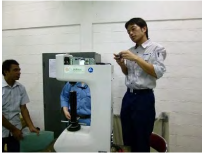
ロックウェル硬度計に不具合があり、その原因を調査中
