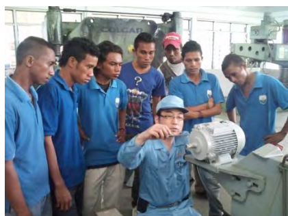
故障していたプレス切断機のモータを新品に取り替え、回転方向を確かめる
