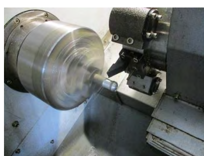
NC プログラム入力後, 実機で 1 回目の加工を行っている様子。削り残しのミスが見受けられる。
