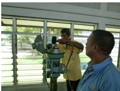
ボール盤主轴回転数変換用 V ベルトの張り調節部の動きが悪い ため、分解、調整、組立を行った
