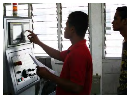
CNC 旋盤の NC プログラム編集。この後, 工具位置設定, 工具データ入力等を行い, 加工へと進む。
