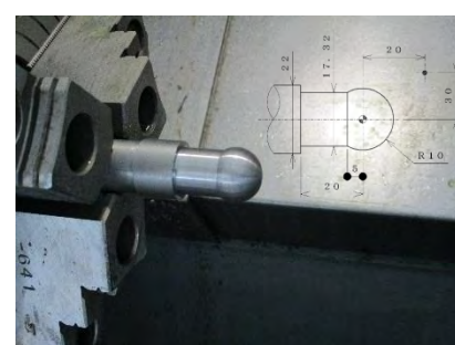
CNC 旋盤による軸付球体の完成品。教官の研究用部品として大量生産する予定でいる。
