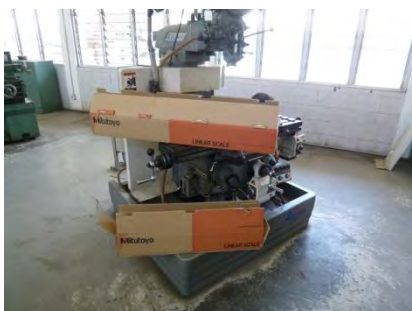
携行機材でのリニアスケール。 上が X 軸用、下が Y 軸用。 縦フライス盤のメンテナンス開始。
