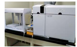
微量元素分析や同位体比測定で用いる誘導結合プラズマ質量分析装置 (ICP-MS)
