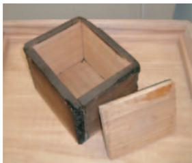
図12 抗燻箱 燃焼実験後
