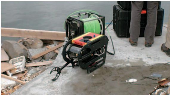
図1 水中ロボットの例 (SeaBotix社製SARbot[8])
