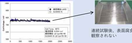
窒素処理フェライト系ステンレスは、電気化学反応場である燃料電池内においても腐食しない炭素セパレータ同等の高耐食性を示す。
